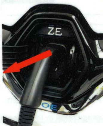
Lösen Sie zuerst die Verbindung vorne am Fahrzeug und anschließend am Ladepunkt: Ziehen Sie dazu den **Ladestecker** möglichst **gerade aus der Buchse**. Halten Sie dabei die Stecker immer gut fest, damit diese nicht auf den Boden fallen können. **Schließen** Sie dann die innere und die äußere **Ladeklappe** am Fahrzeug.
