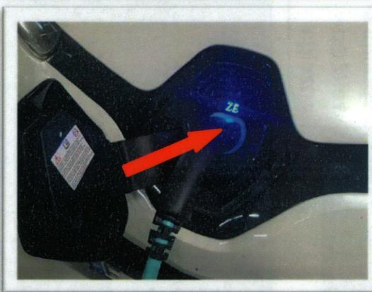
Schließen Sie jetzt zuerst die Verbindung am Fahrzeug an, anschließend am Ladepunkt (die Art des Anschlusses variiert je nach Ladesäule). Stecken Sie dazu das **Ladekabel** immer fest und möglichst **gerade in einem Zug** ein.
