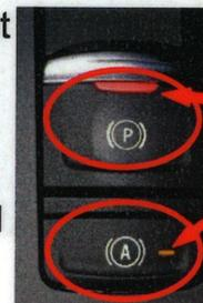
Schalter für Handbremse:
